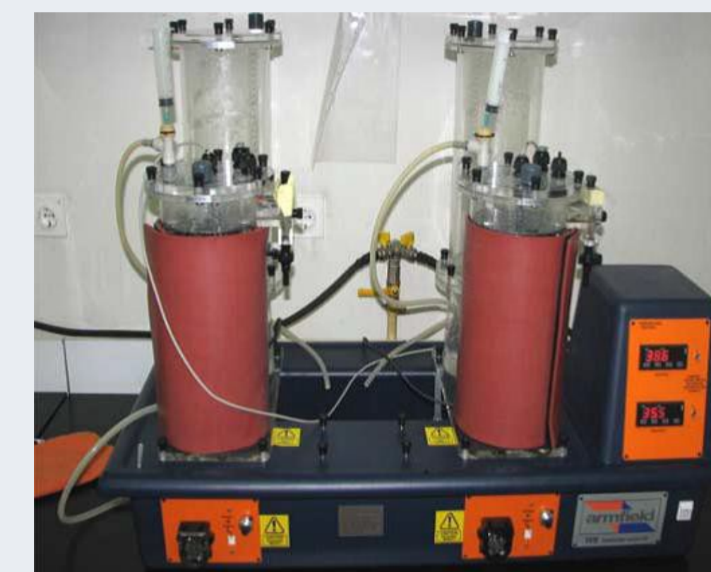
Provedba pokusa u uređaju za anaerobnu digestiju
